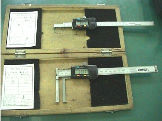
(7) 深度游标卡尺：主要用于测量阶梯、盲孔沟槽等深度尺寸
