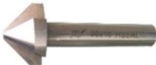
主要用于模具的内孔倒角及外型倒角。倒角角度分为60度，90度，120度，市面上90度倒角居多，齿数分为1F和3F。
